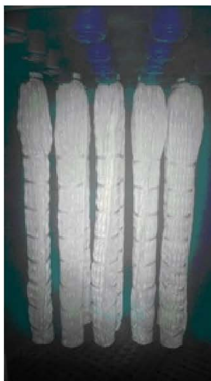
Рис. 14. Сборка фильтра с рукавами «3DESA фильтрпатрон» с увеличенной в 4,6 поверхностью фильтрации
